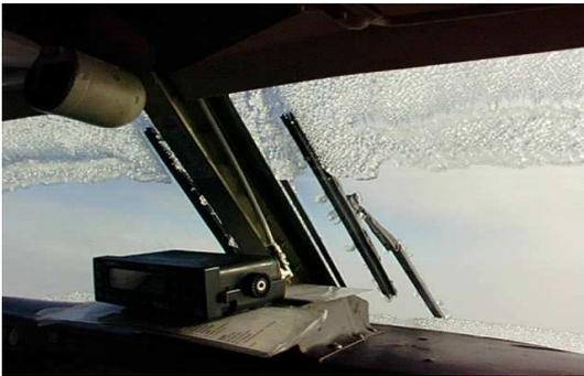
Le **givrage** est dû à la **présence d'eau** sous forme **liquide** à des **températures négatives**.
